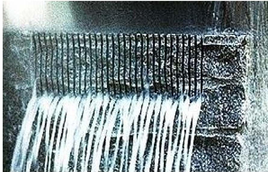
Figura 2 - Corte de blocos de granitos com auxílio de lama abrasiva.
