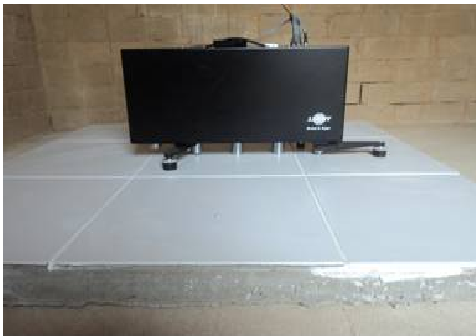
Figura 1. Amostra referencial composto por contrapiso (4 cm) revestido com cerâmica sobre laje pré-moldada convencional (espessura = 10 cm).
