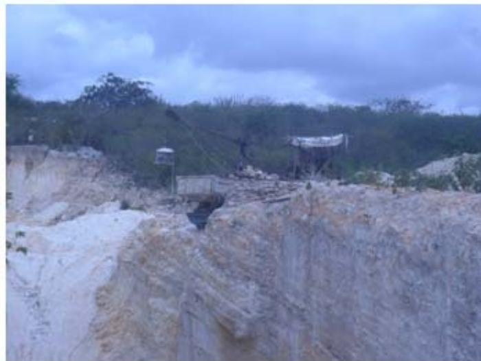
**Figura 2** - Banquetões a céu aberto com uso de guincho e motor a diesel.
