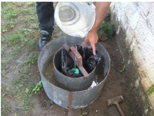
**Figura 3.** Ensaio Taxa de Infiltração. Fonte: Do autor, 2013.
