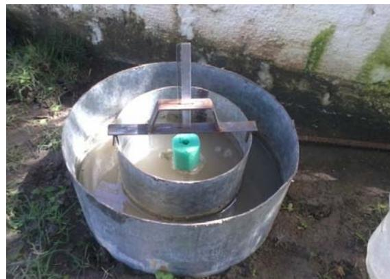
**Figura 4.** Ensaio Taxa de Infiltração. Fonte: Do autor, 2013.
