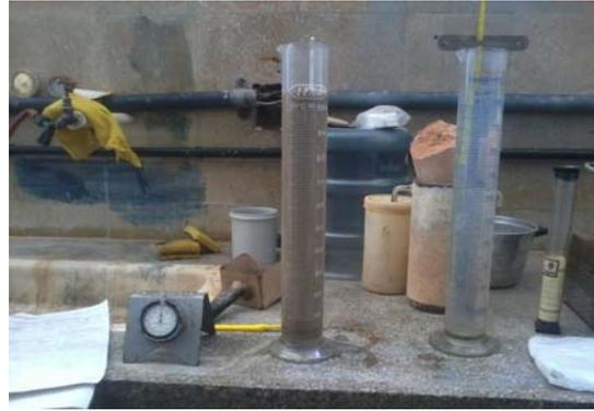
**Figura 2.** Ensaio de sedimentação do solo. Fonte: Do autor, 2013.
