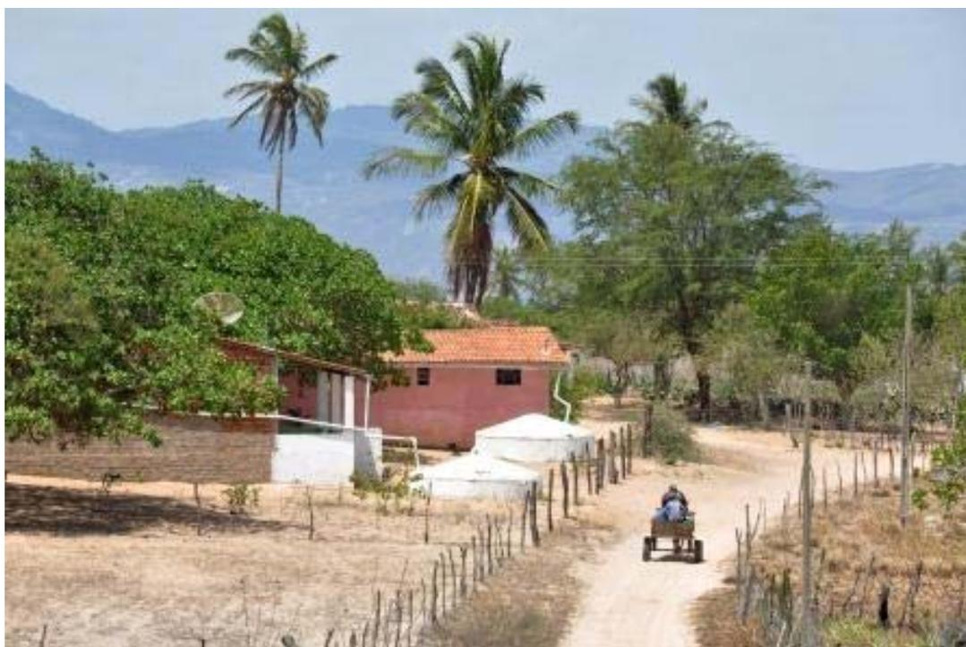
**Figura 1.** Cisternas com capacidade para 16 mil litros do Programa Um Milhão de Cisternas (P1MC), da Articulação no Semiárido (ASA). Fonte: Paulo Lopes – Arquivo Fotográfico da ASA (2014).
