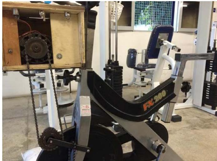
**Figura 2.** Sistema adaptado para captação de energia usando um alternador automotivo.
