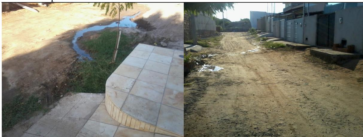
**Figura 3.** Infiltração aparente em frente a residências e escoamento das águas dos sumidouros na rua.
