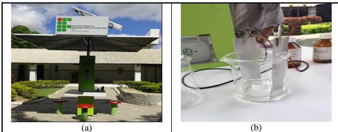
**Figura 1.** a) Protótipo sistema fotovoltaico; b) Montagem do reator eletroquímico para eletrofloculação da água de lavagem do biodiesel:
