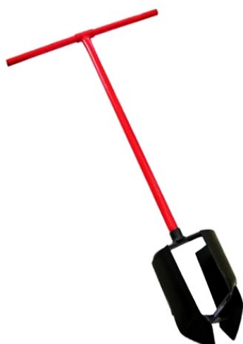
Figura 2. Trado utilizado nas perfurações manuais de poços artesanais. Fonte: www.mfrural.com.br .
