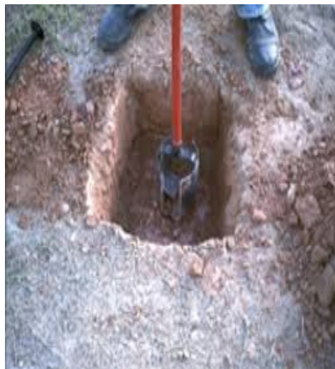
Figura 2. Trado utilizado nas perfurações manuais de poços artesanais. Fonte: www.mfrural.com.br .
