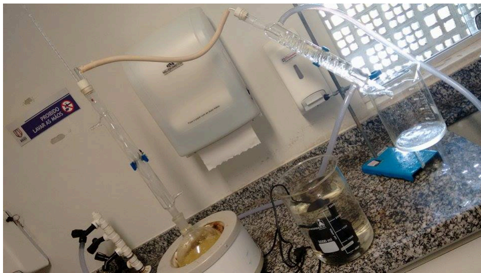
Figura 1. Processo de arraste a vapor, para produção do D-Limoneno.
