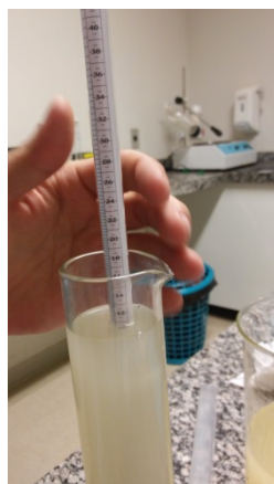
Figura 2. Medição da porcentagem do álcool produzido utilizando um decímetro na escala Gay-Lussac
