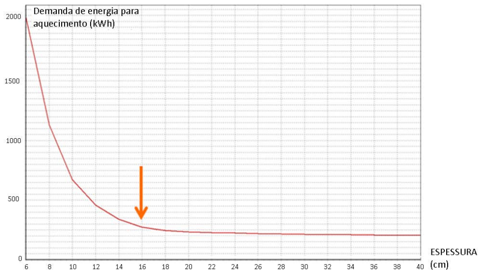
Figura 7. Efeito da espessura do isolante sobre a capacidade de isolamento das paredes.
