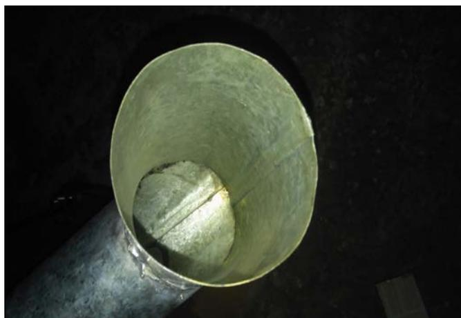
**Figura 4.** Saída do filtro após tratamento
