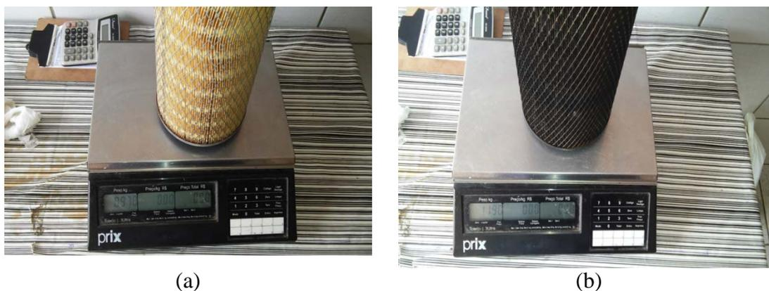
**Figura 3.** (a) Filtro antes do uso; (b) Filtro após uso
