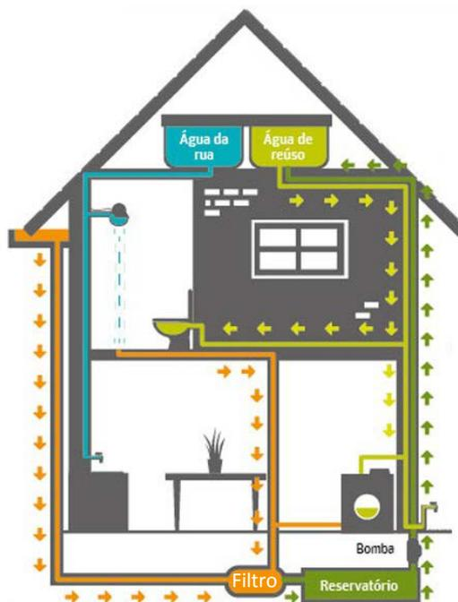
**Figura 4.** Esquema de reaproveitamento das águas cinzas. Fonte: Sinduscom (USP).
