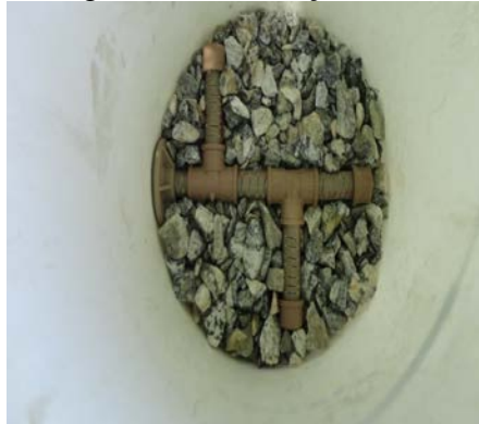
a) Cano perfurado para drenagem
