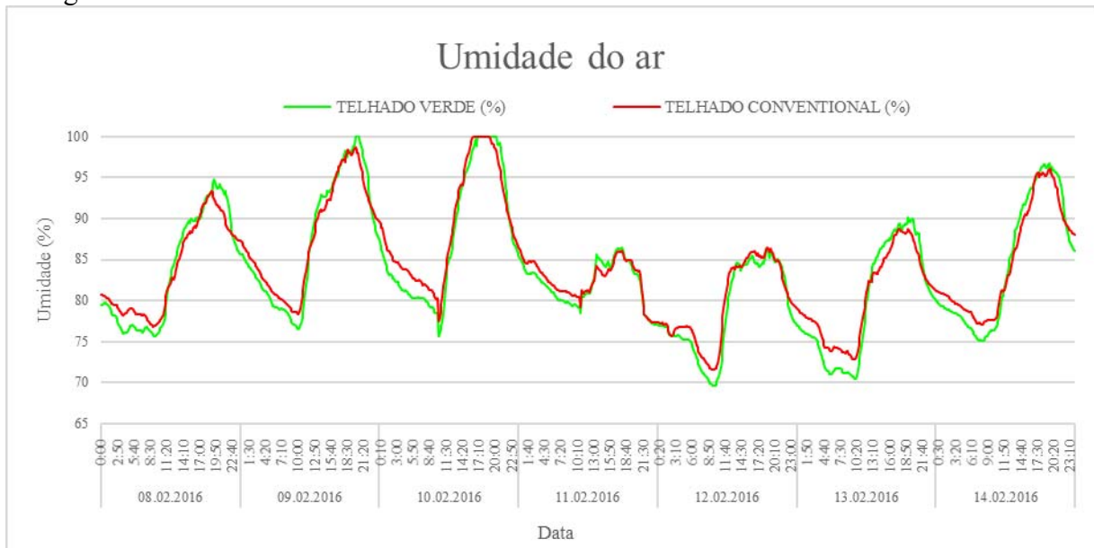
Figura 9: Umidade relativa do ar entre dois telhados
