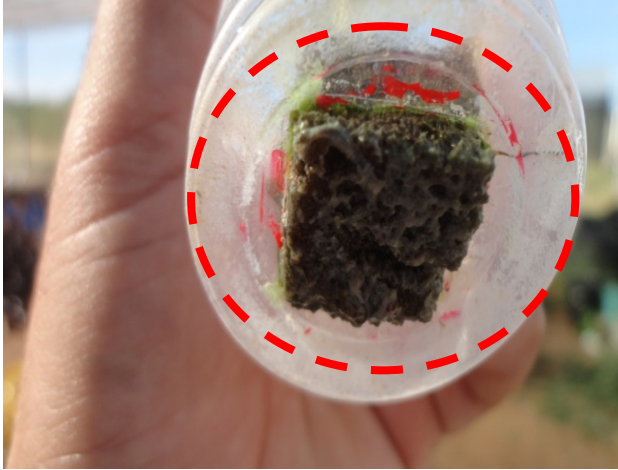
Figura 6- Óleo e gordura da água cinza aderida a espuma fenólica.
