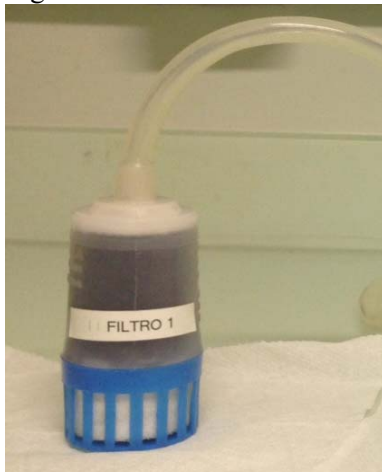
Figura 3: Filtro de carvão comercial utilizado na pesquisa
