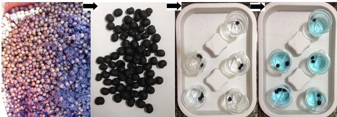
Figura 02 – Carvão ativado de resíduos do açaí em sua granulometria natural e adsorção em azul de metileno.
