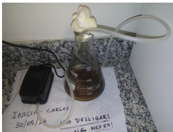
Figura 1: Erlenmeyer com o fungo e a solução de corante Remazol Black B. Sendo filtrados, agitados e oxigenado pela bomba de ar
