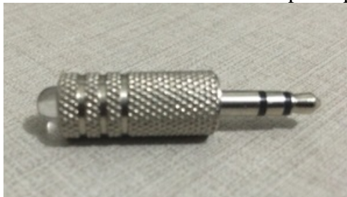
Figura 2 - Dispositivo emissor infravermelho adaptado pelo autor.
