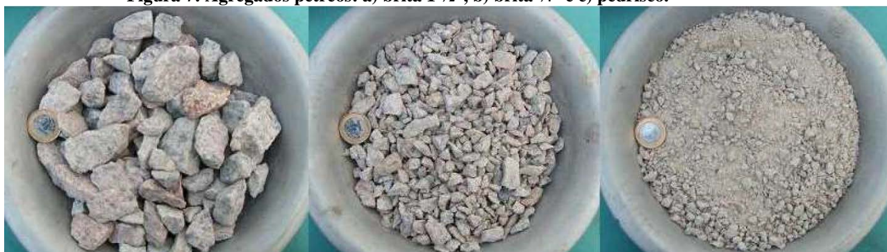
Figura 7: Agregados pétreos: a) brita 1 1/2", b) brita 3/4" e c) pedrisco.
