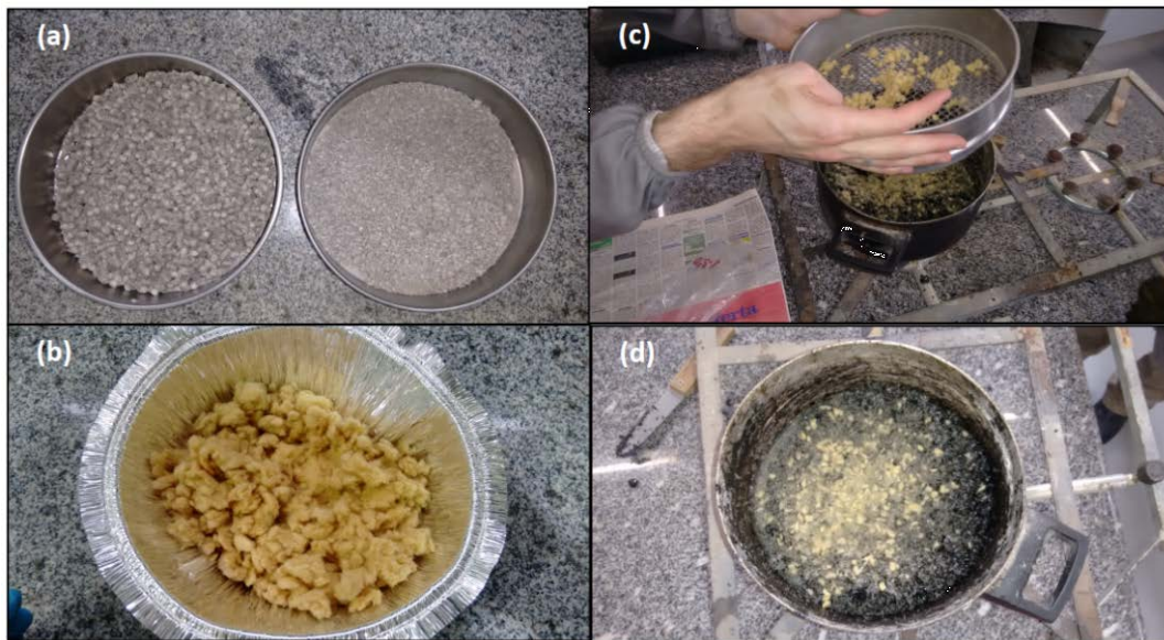
Figura 28: Preparação das amostras para ensaio de escorrimento.
