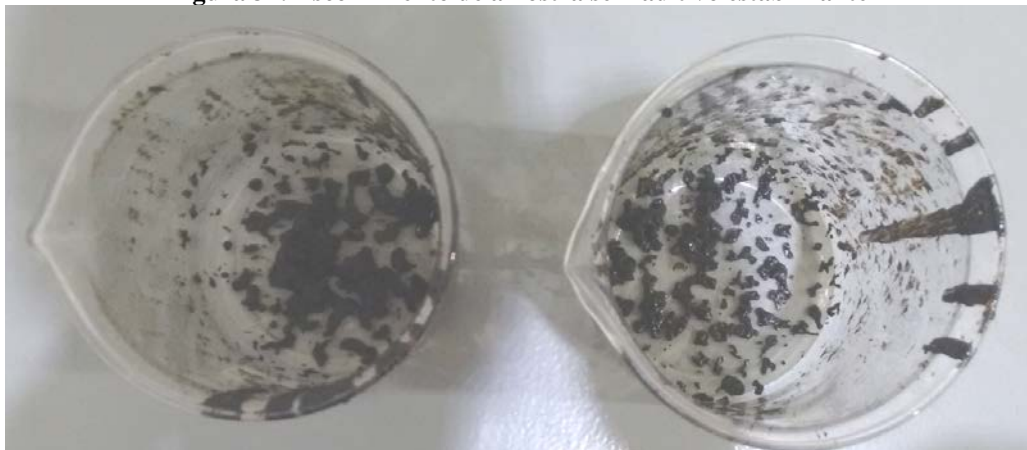
Figura 32: Escorrimento de amostra sem aditivo estabilizante
