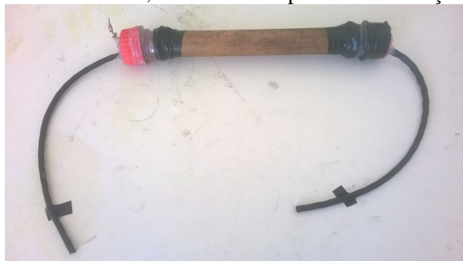
Figura 4 – Reator gerador de ozônio (Fonte: Autoria própria)
