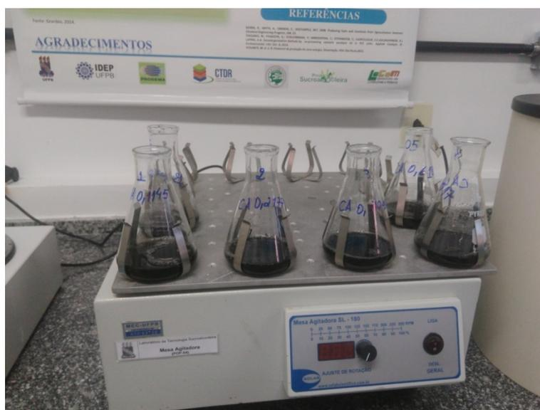
**Figura 1.** Experimento dos testes de adsorção da vinhaça com carvão ativo.
