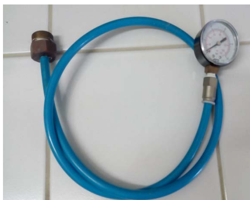
Figura 2. Manômetro GE em escala psi, acoplado a mangueira de pressão e adaptador de rosca 3/4" e 1/2". Fonte: Própria (2017)
