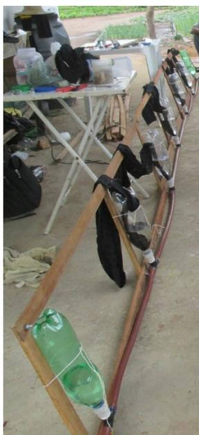
**Figura 2a.** SISCAFI montado em grade de madeira, para testes de vazamento.
