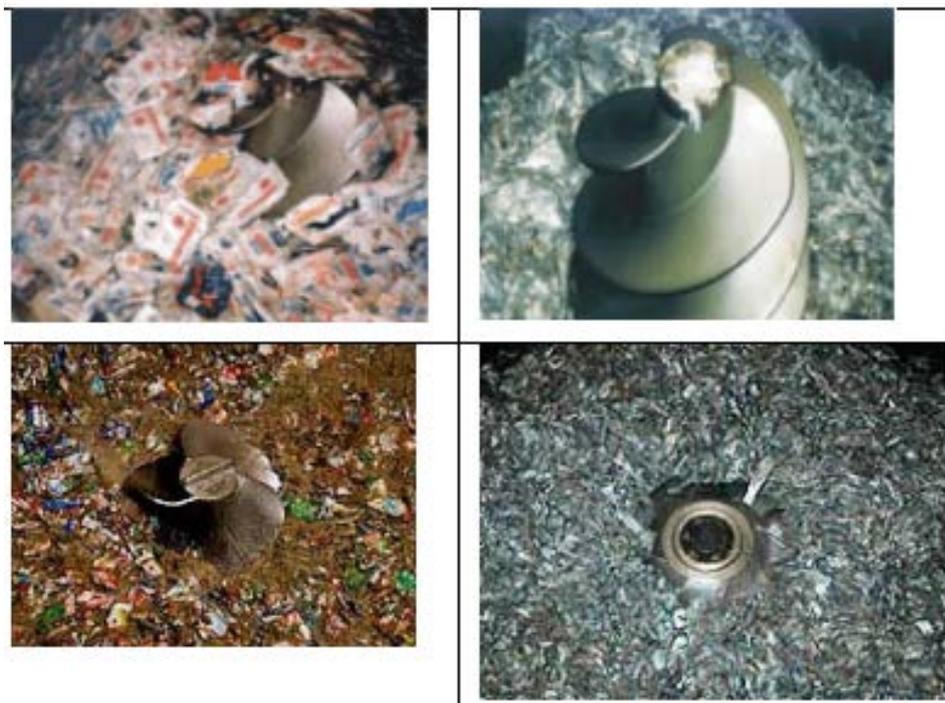
**Figura 2.** Início do processo de reciclagem - Hidrapulper. Fonte: ABRE (2009) e TETRA PAK (2009).
