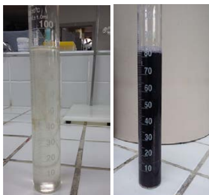
Figura 8. Solução de amido/iodeto: a) Solução não oxidada; b) Solução oxidada. Fonte: Autoria própria
