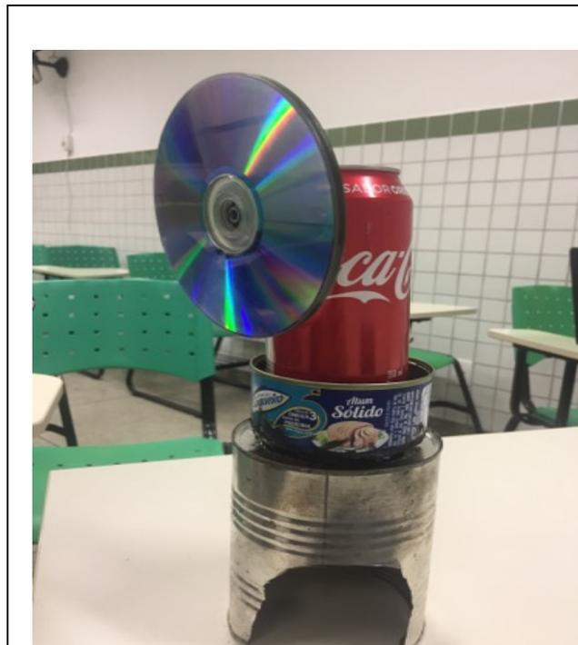
**Figura 5.** Motor Stirling após finalização da montagem. Fonte: Autoria Própria.
