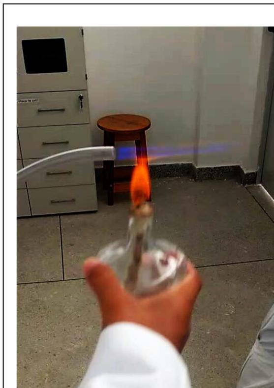
**Figura 6.** Queima do gás proveniente do biodigestor. Fonte: Autoria Própria
