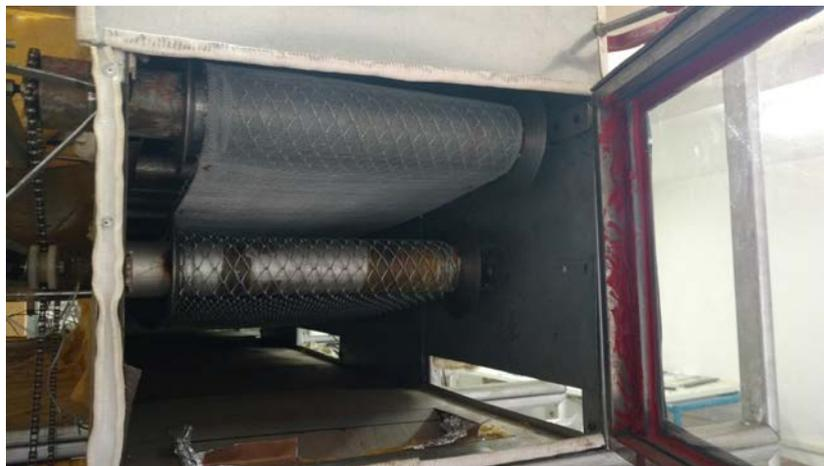
**Figura 1.** Esteira do secador elétrico. Fonte: Brasileiro (2017).
