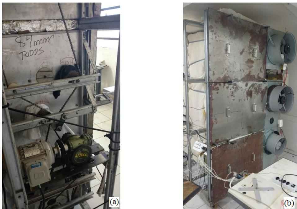
Figura 2. Estrutura, motor e ventiladores do secador elétrico. Fonte: Brasileiro (2017).
