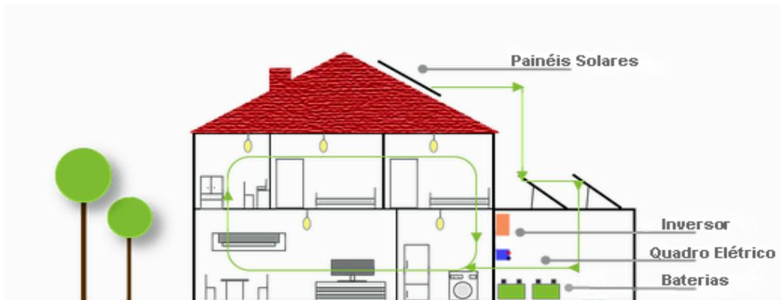
**Figura 2.** Sistema off-grid. Fonte: [www.d-solarsystems.com/autoconsumo](http://www.d-solarsystems.com/autoconsumo).
