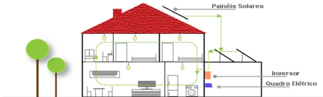
**Figura 1.** Sistema on-grid. Fonte: [www.d-solarsystems.com/autoconsumo](http://www.d-solarsystems.com/autoconsumo)
