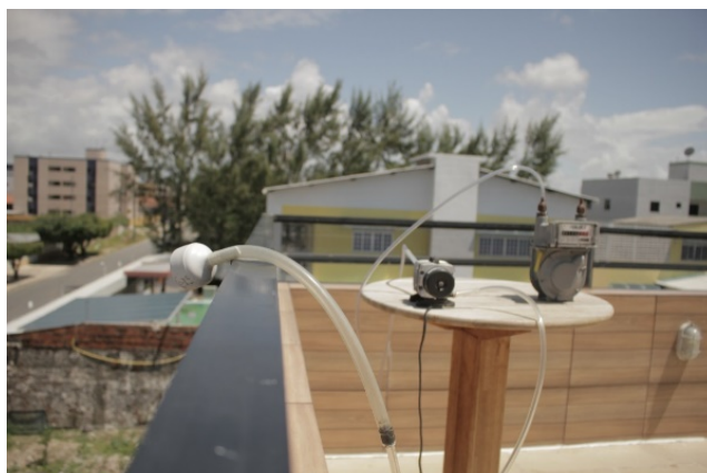
Figura 4. Sistema de amostragem ativa de baixo custo.
