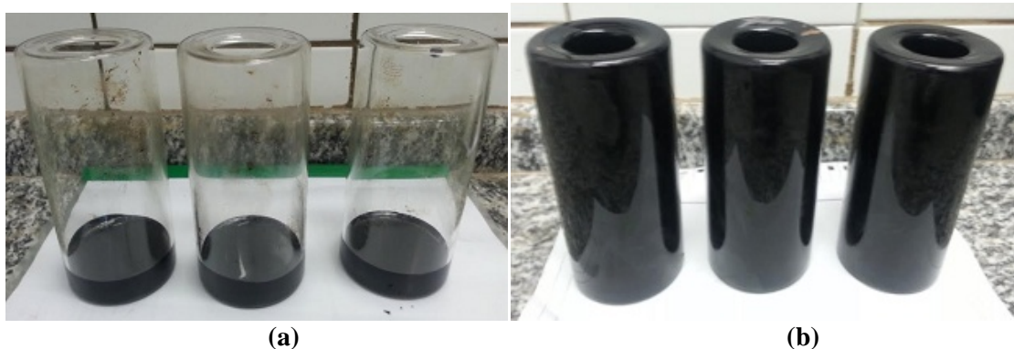
Figura 2. Amostras de ligante: a) antes e b) após envelhecimento no RTFOT. Fonte: Os autores (2017).
