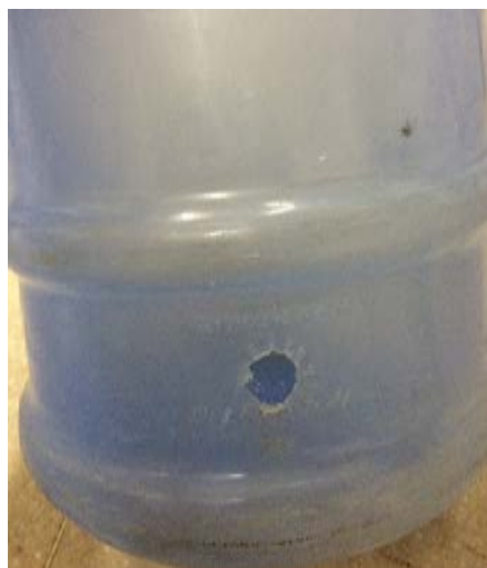
Figura 3 e 4. Orifício de 3 cm de diâmetro na parte inferior do galão. Fonte: Autora (2018).
