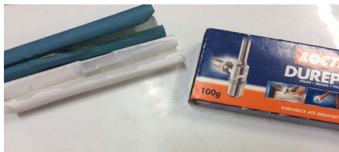
Figura 2. Cola epóxi para vedar as rachaduras. Fonte: Autora (2018).
