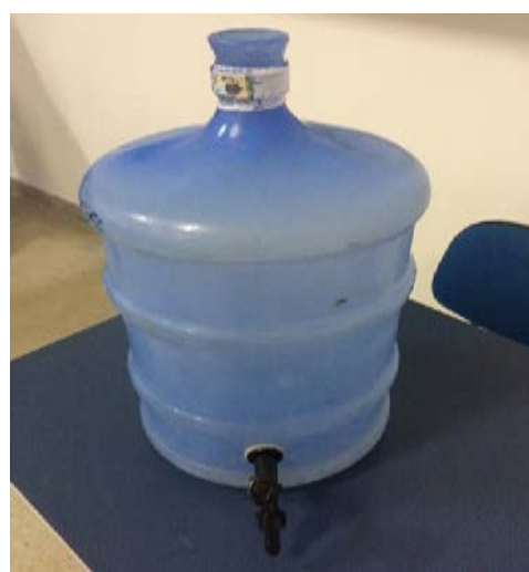
Figura 5 e 6. Torneira colada no orifício inferior do galão. Fonte: Autora (2018).
