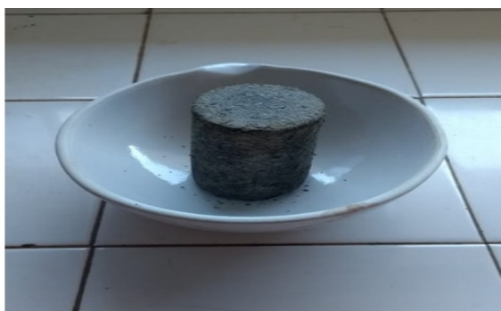
Figura 16. Briquete com 30% de cola. Fonte: Próprio Autor (2018).
