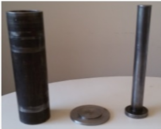
Figura 9 - Forma utilizada para a Briquetagem Fonte: Próprio Autor (2018).
