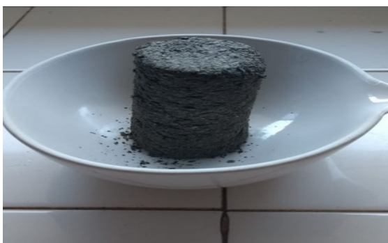
Figura 15. Briquete com 20% de cola. Fonte: Próprio Autor (2018).
