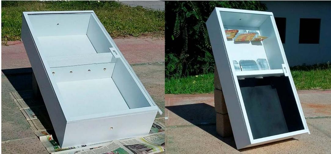
**Figura 1.** Protótipo desidratador de frutas. Fonte: Os Autores (2018).
