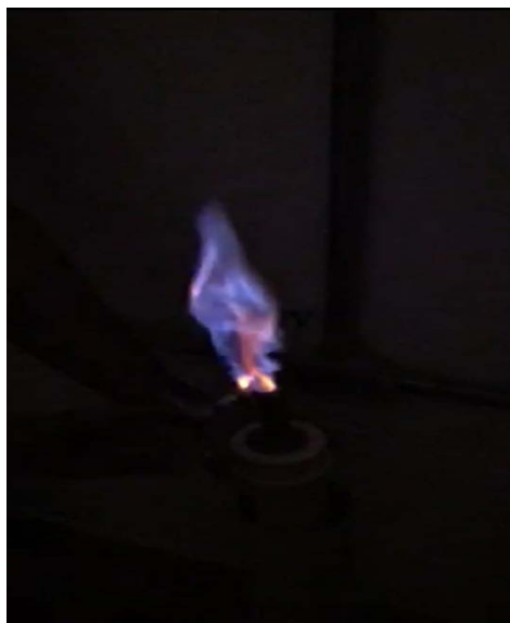
Figura 6. Teste da chama no biodigestor. Fonte: Acervo Pessoal, 2018.
