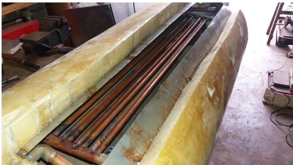
**Figura 2.** Tubos de cobre do reservatório modificado.
