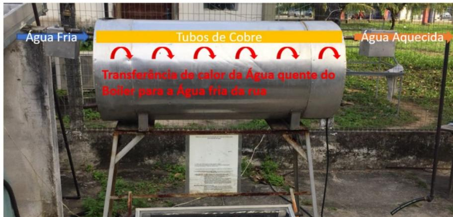
**Figura 1.** Reservatório térmico modificado.
