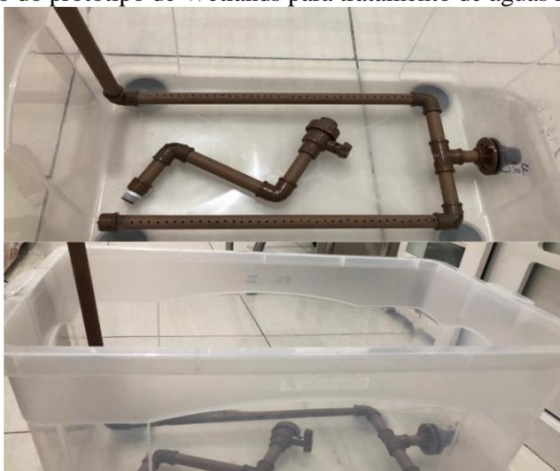
**Figura 1:** Construção do protótipo de Wetlands para tratamento de águas residuais. Fonte: Autoria Própria
