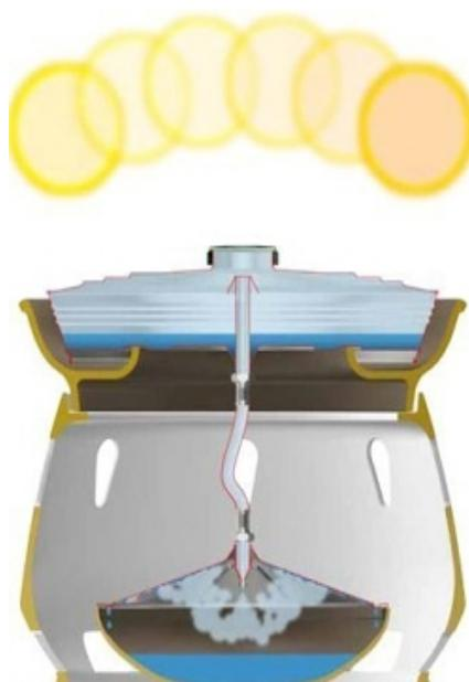
**Figura 11.** Esquema da destilação solar. **Fonte:** Dessalinizadores e seus sensores.
