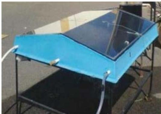
Figura 12. Dessalinizador com fibra de vidro. Fonte: Patil; Hole (2016).
