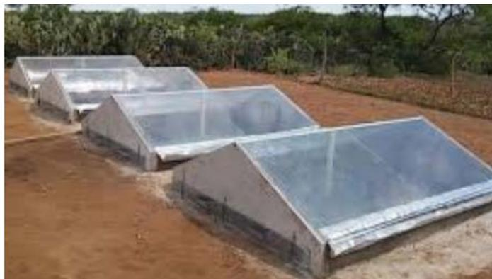
Figura 2. Dessalinizador solar. Fonte: Uchôa, 2016.
