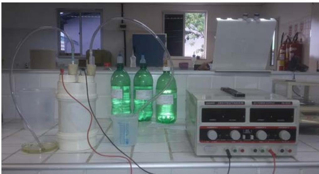
Figura 2. Protótipo do reator eletroquímico.
