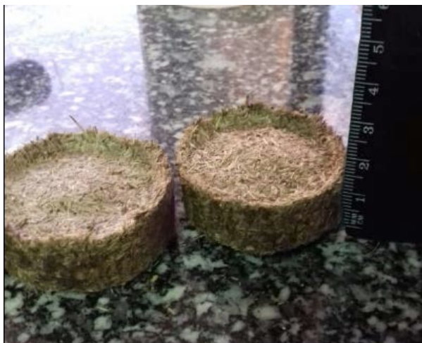
Figura 1. Pellets após retirada da prensa hidráulica.
