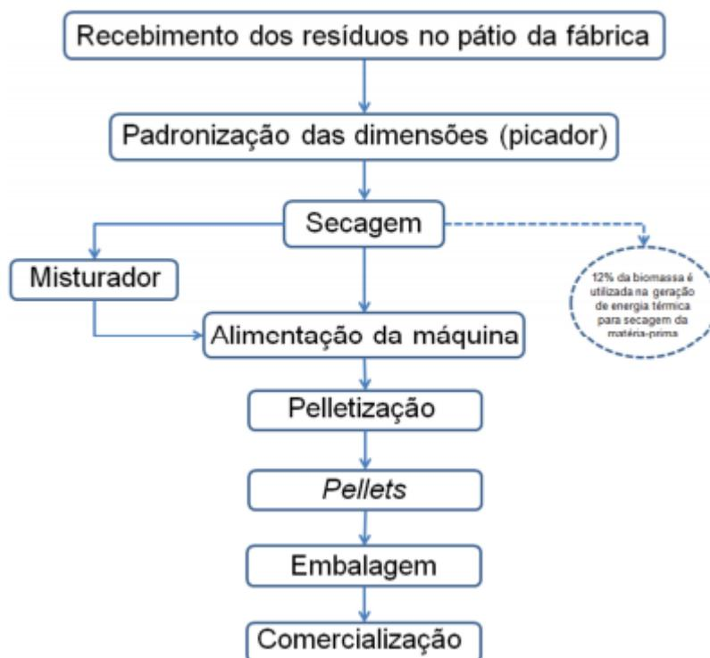
Figura 1. Diagrama com sequência geral de fabricação de pellets. Fonte: Couto (2004).
